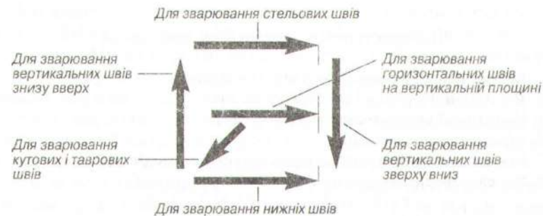
Рис. 6.4. Умовні позначення допустимих просторових положень зварювання електродів закордонного виробництва
