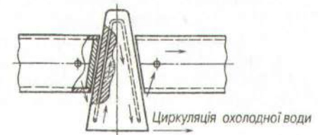
Рис. 11.11. Схема клинового з'єднання стику внутрішнього формуючого кільця
