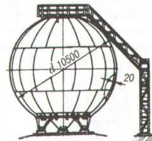
Рис. 20.51. Сферичний резервуар об'ємом 600 м 3
