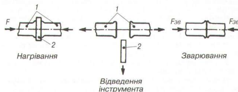
Рис. 18.1. Схема контактної теплової зварювання нагрітим інструментом:
