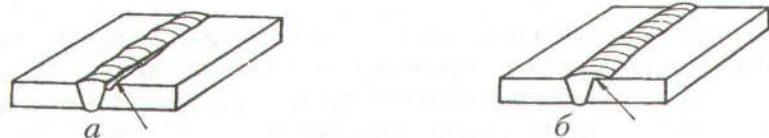
Рис. 22.4. Дефекти зварних швів: а — підріз; б — наплив
