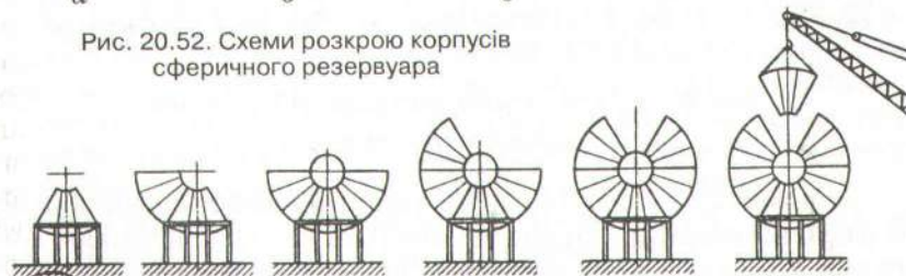
Рис. 20.53. Послідовність збирання резервуара методом послідовного нарощування при горизонтальній орієнтації блоків
